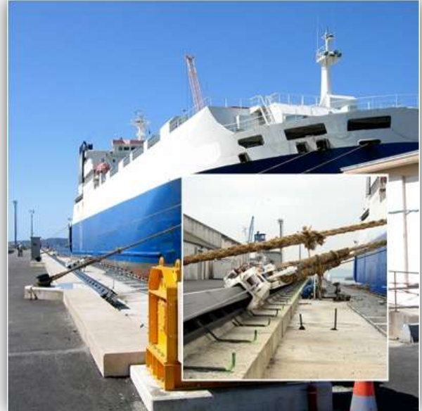
Le dispositif de halage en forme 1
