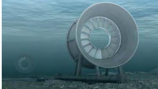
La société Sabella SAS développe également un concept d'hydrolienne totalement immergée. Un prototype à échelle réduite a été testé dans l'estuaire de l'Odet, en Bretagne, en 2008 et 2009 (fig. 5). A terme, l'hydrolienne Sabella devrait mesurer 10 m de diamètre et développer une puissance de 200 kW. Plusieurs hydroliennes pourraient être déposées en écran pour constituer des unités de 1 MW.
