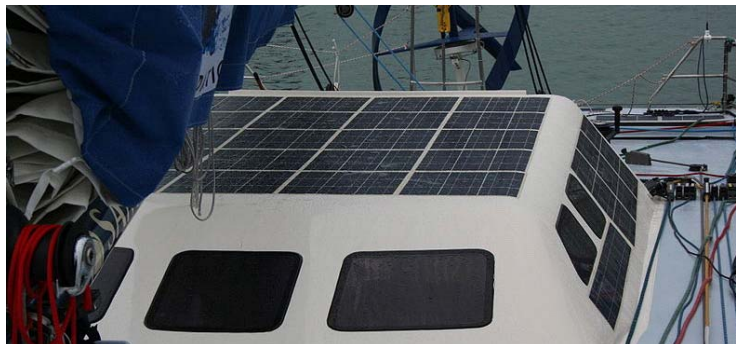
Figure 94. Les panneaux solaires d'Ocean Vital.
