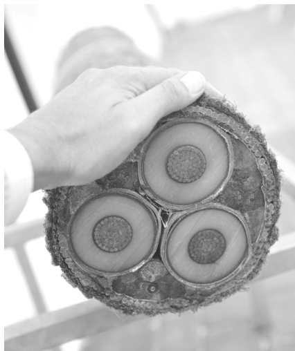
Figure 17. Câble servant à raccorder les parcs danois au réseau électrique.
