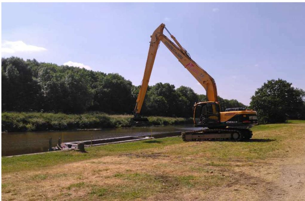
*Déchargement d'une barge et transfert dans un tracto-benne pour acheminement vers un site de transit.*
