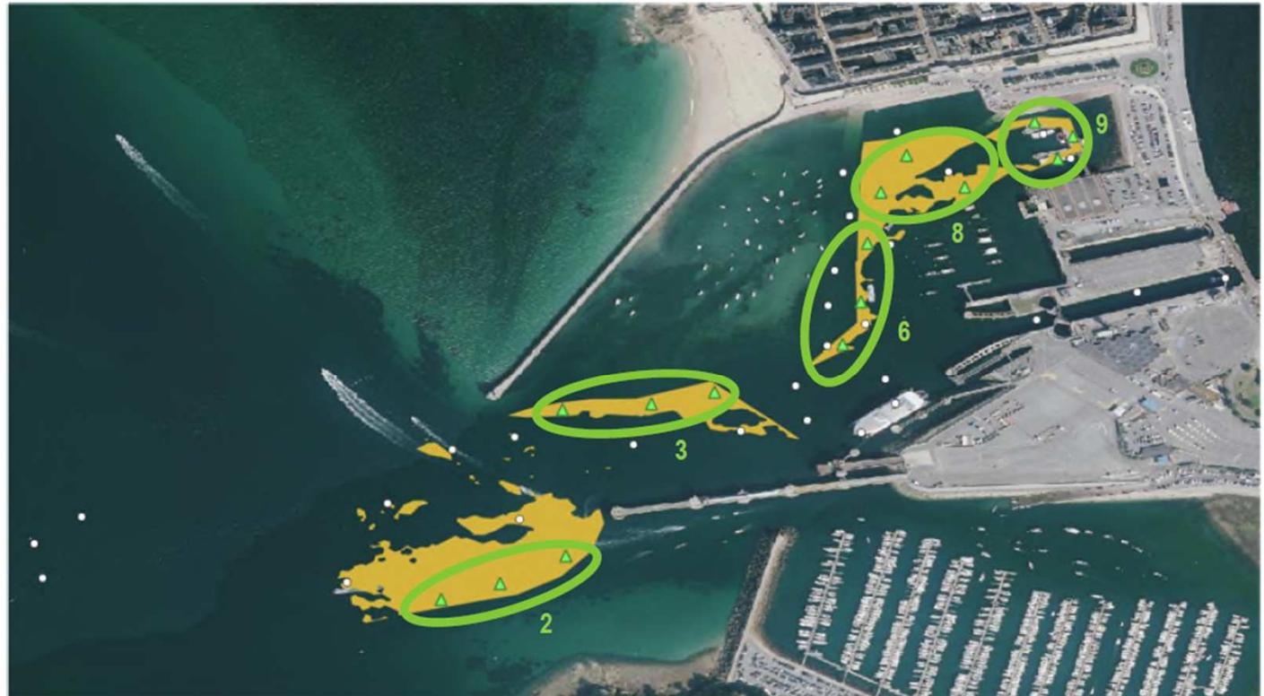
*Localisation des zones de dragage, des prélèvements réalisés précédemment (points blancs) et des prélèvements à réaliser (triangles verts)*
