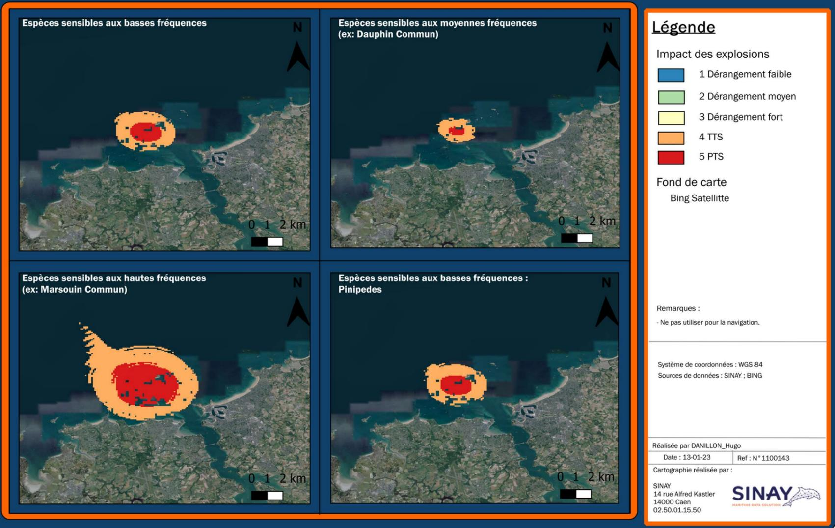
Figure 43: Impact du bruit impulsif du minage en zone 1, avec rideau de bulles.
