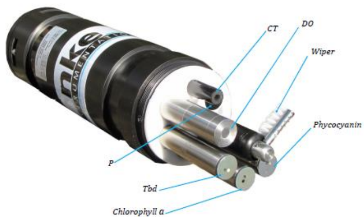
Figure 2 : Position des capteurs sur une sonde SAMBAT
