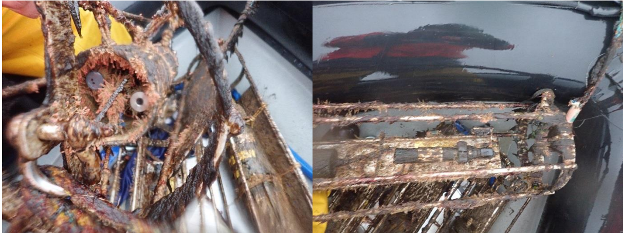
Photo 3 : Sonde à la fin de la première période d'acquisition, présentant du biofouling
