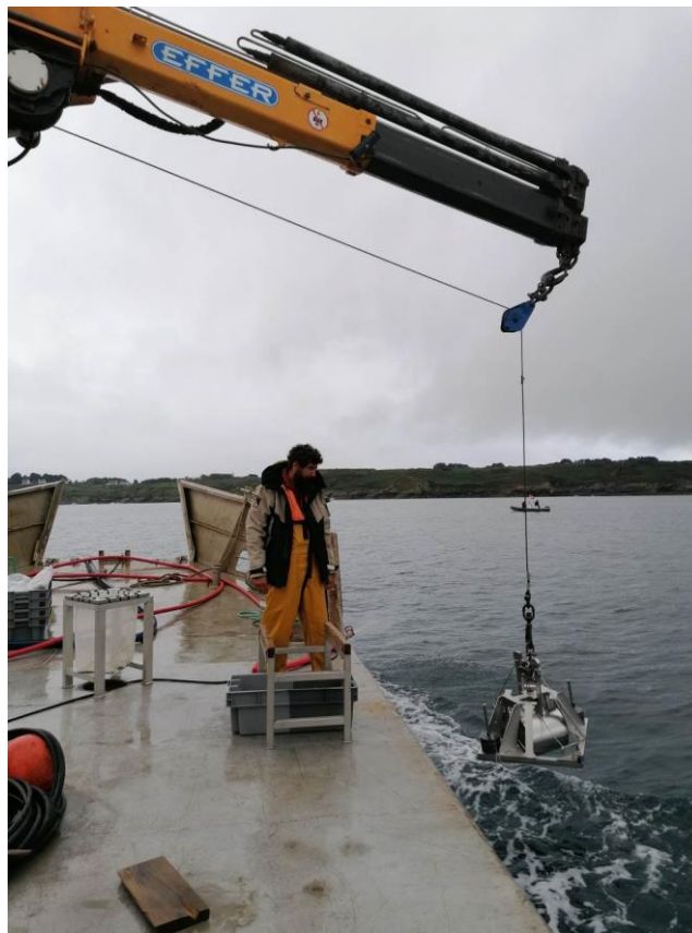
Figure 7 : Benne Day et tamis (cliché TBM)
