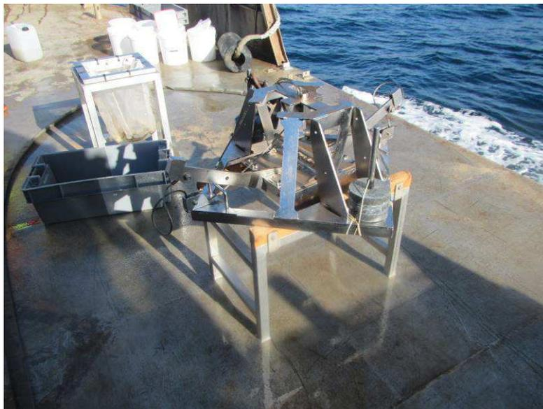
Figure 2 : Benne Day et tamis (cliché TBM)
