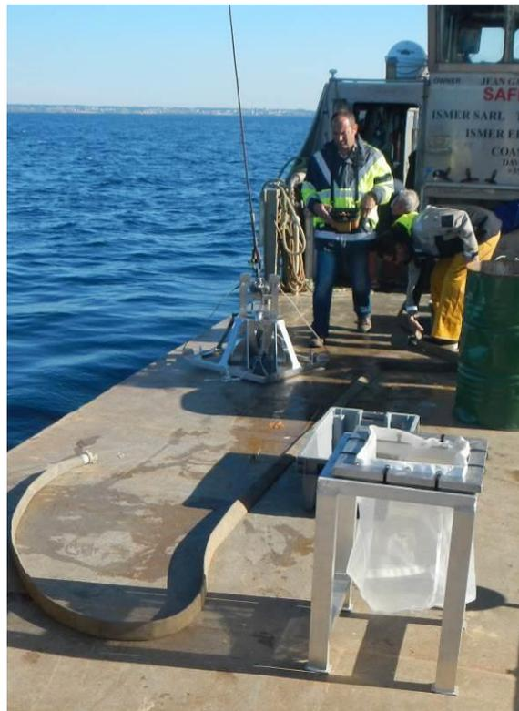
Figure 1 : Benne Day et tamis (cliché TBM)
