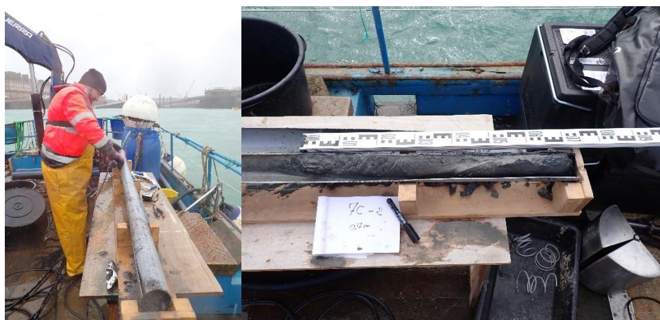
Photo 3 : ouverture des carottes
