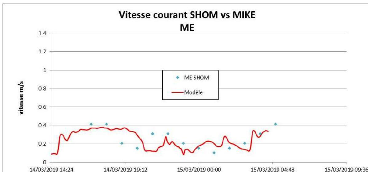
**Figure 2-4 : Comparaisons des vitesses calculées par le modèle et mesurées par le SHOM au point E (carte 7130) en Morte-eau (coefficient 45)**
