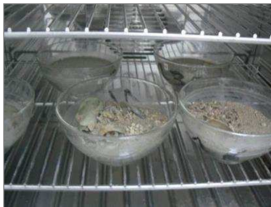
Figure 6 : Echantillons granulométriques à l'étuve (Cliché TBM)
