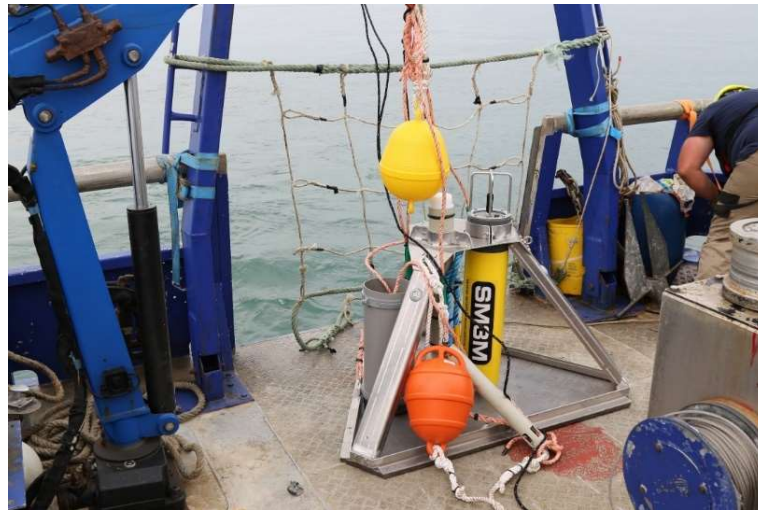
Figure 10: Cage n°2 anti-chalutage avec l'enregistreur « Wildlife SM3M » fixé au milieu du support, CPOD-944, Largeur acoustique
