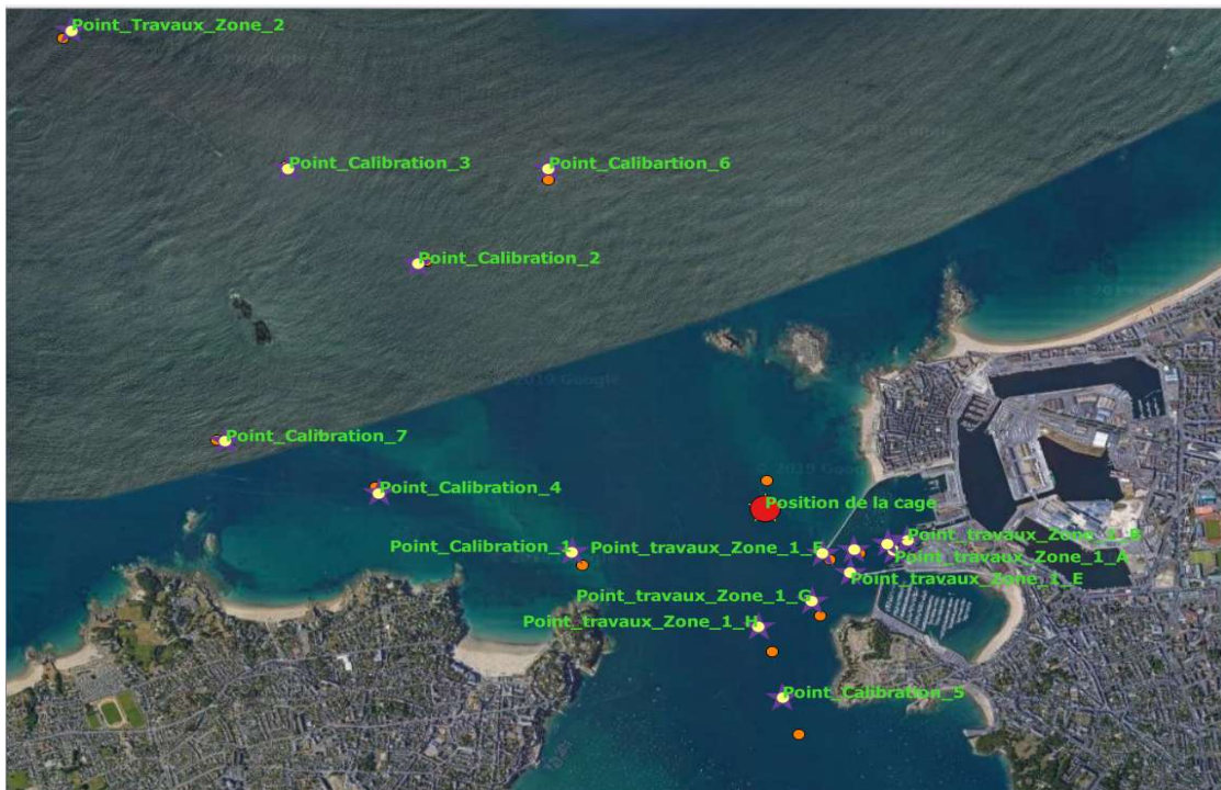
Figure 72: Les emplacements des cages et les points d'émissions de la campagne de calibration le 09/04/2019 Les points jaunes présentent le début d'émission, le point rouge présente la position de la cage (enregistreur) et les points orange présentent les positions finales de l'émission.
