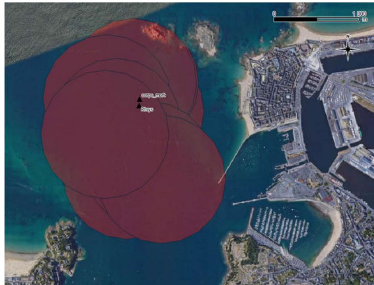
Figure 18: Positionnement du matériel immergé (triangles noirs) et de la surface de la prospection réalisée avec la valise acoustique (cercles rouges).
