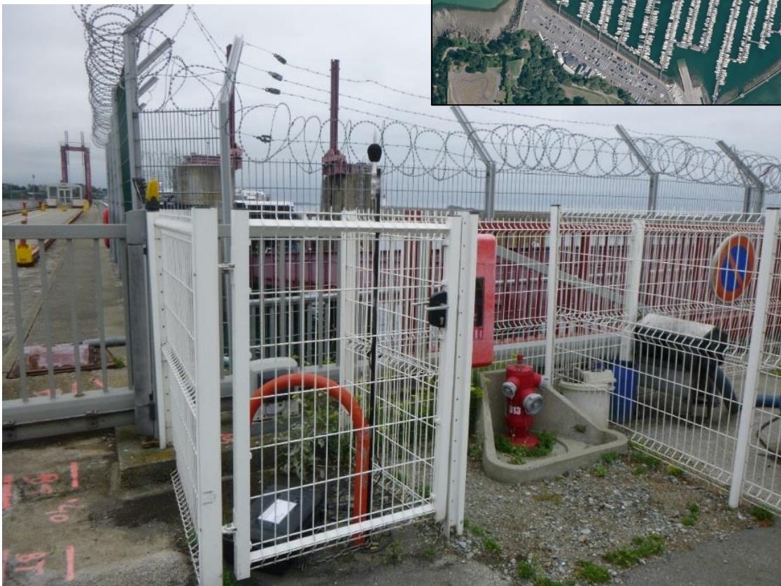
Mesure acoustique (mouchard) pour caractériser la source « ravitaillement des ferries » (© SCE)
