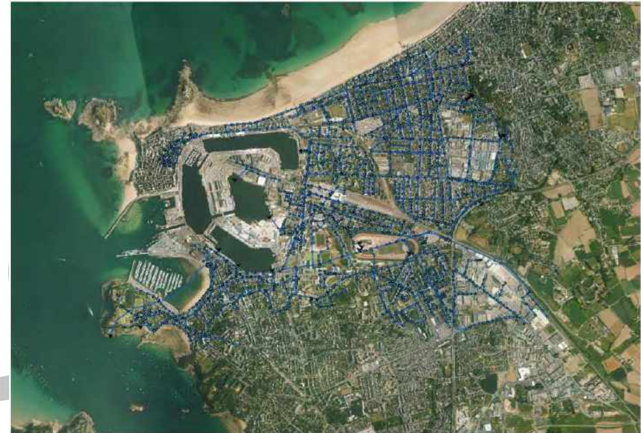
Figure 158 : Réseau d'assainissement modélisé sur la zone d'étude. Source : Plan de prévention des risques littoraux de Saint-Malo
