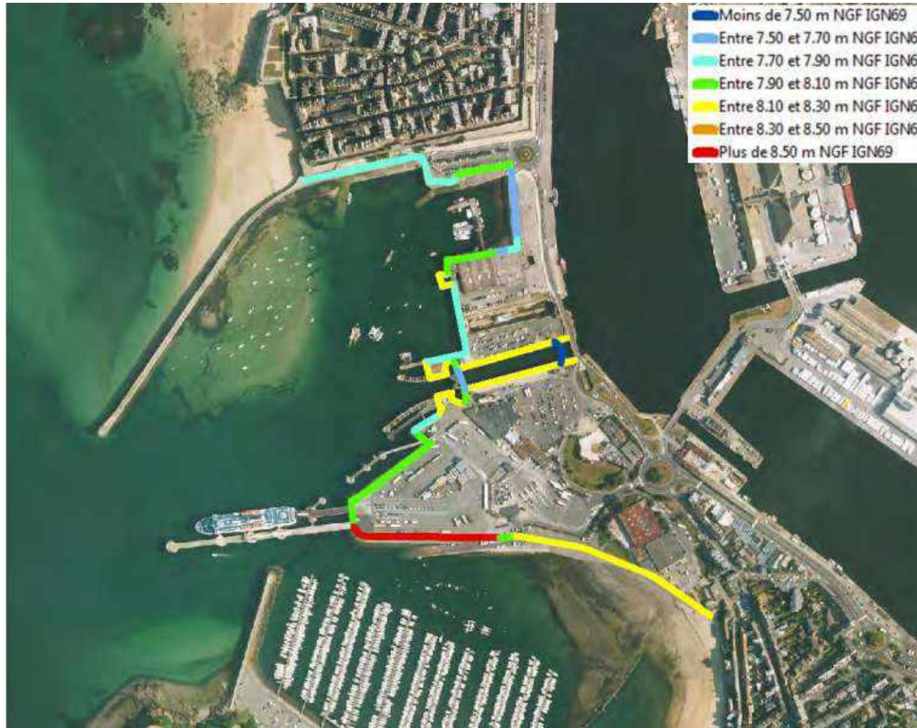
Figure 166 : Altimétrie des différents ouvrages sur le terminal. Source : DHI, 2017
