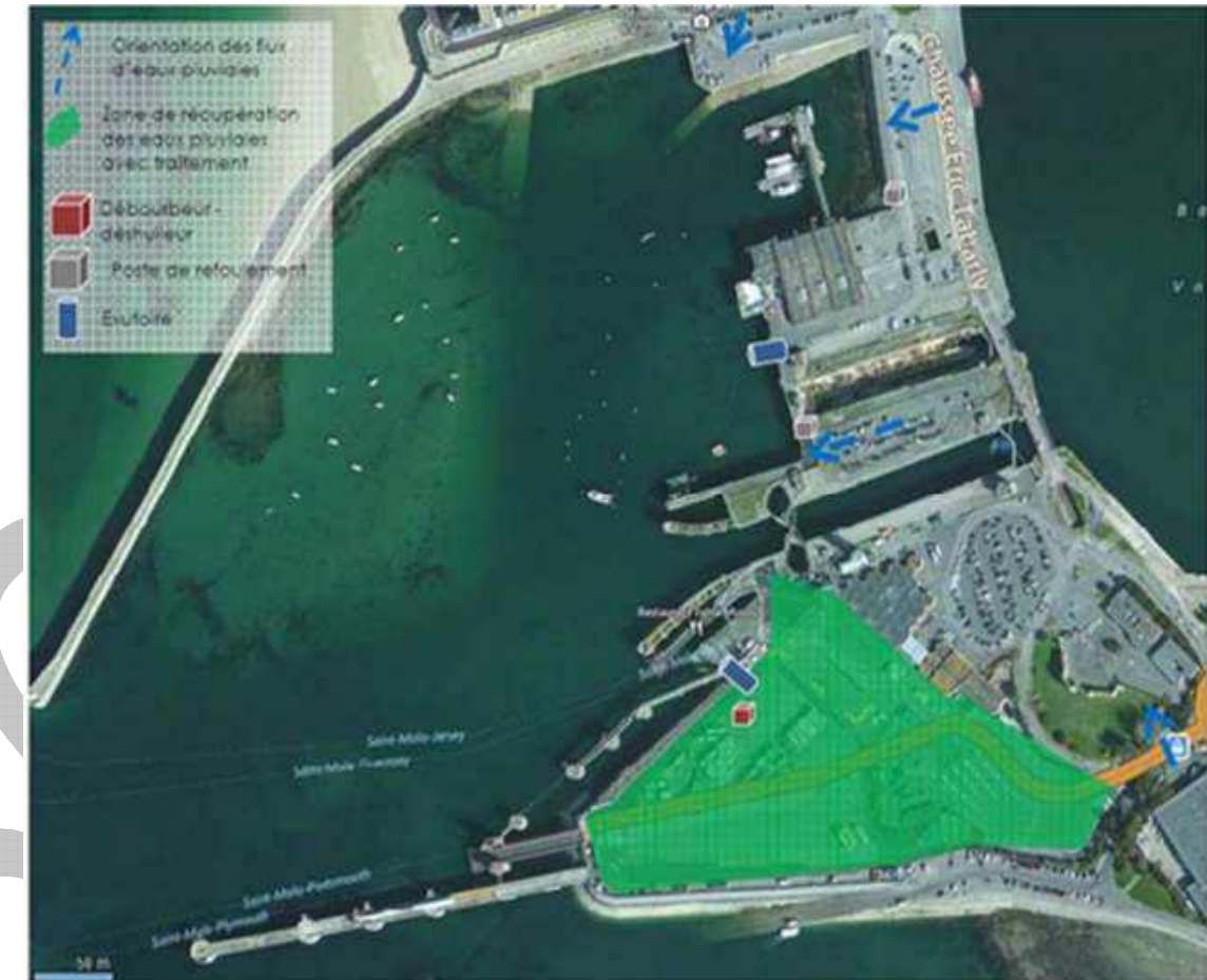
Figure 159 : Réseau de récupération des eaux pluviales du terminal du Naye, Source : IDRA 2014
