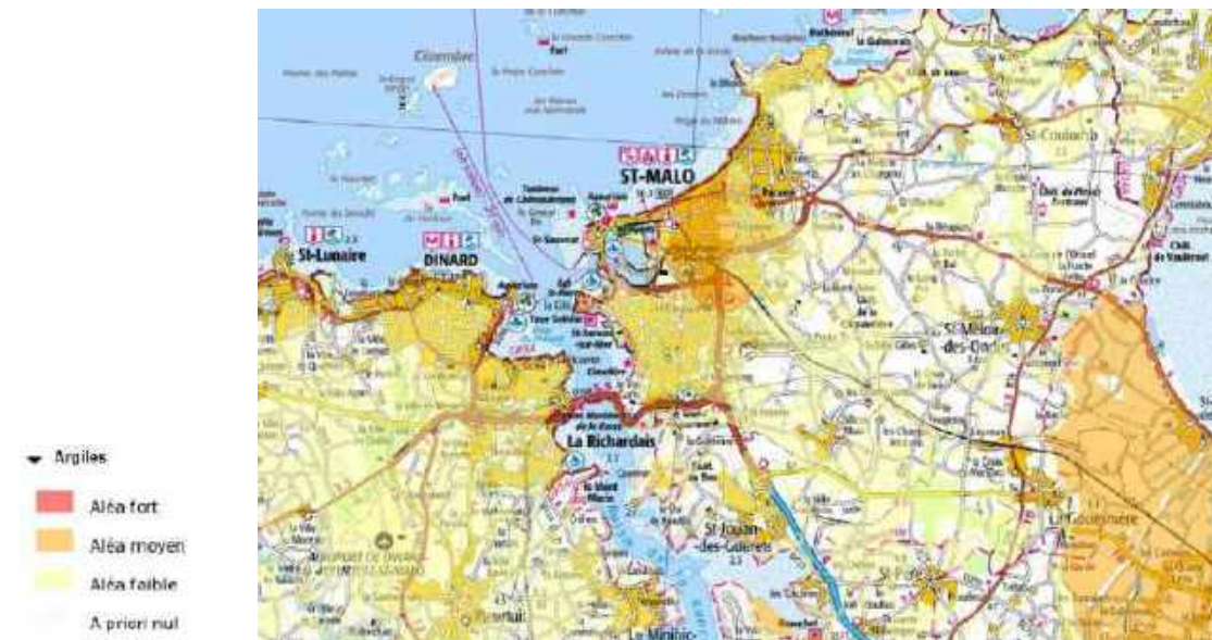
Figure 168 : Aléas de gonflement des argiles. Source : Géorisques
