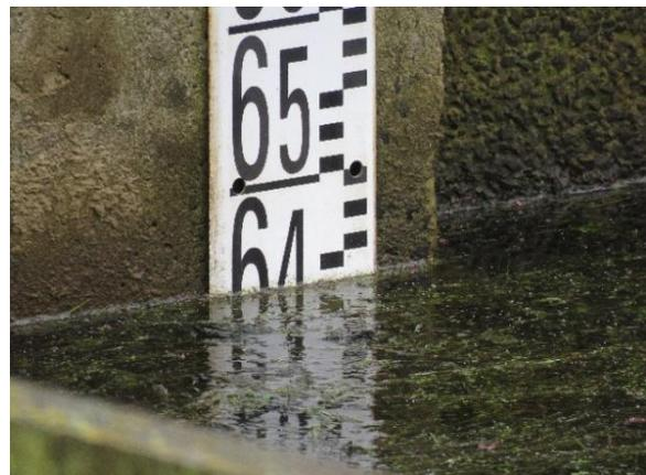
PHOTO 28 : ECHELLE LIMNIMÉTRIQUE (A. BELLANGER)
