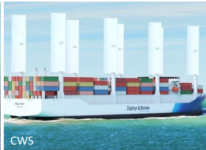
Aile asymétrique Souple Rigide
