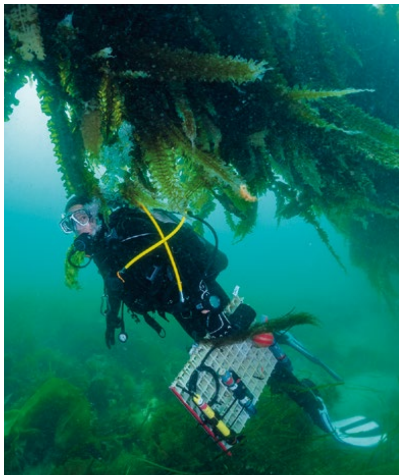
Plongeur du LEMAR (Laboratoire des sciences de l'environnement marin) sous la filière de Saccharina latissima située à l'Aber Wrach positionnant une sonde pour effectuer un suivi de conditions physico-chimiques. © Erwan Amice
