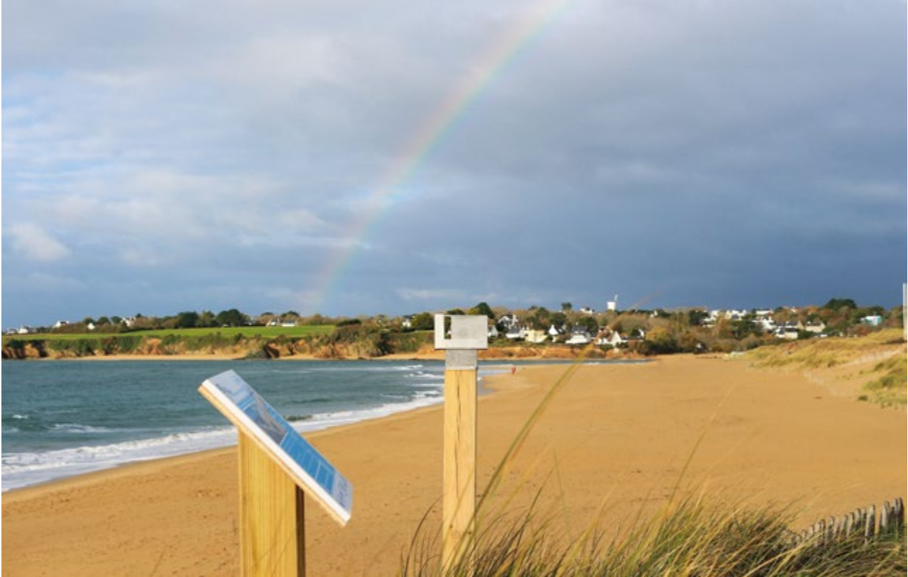
📍 Dispositif photographique de suivi du trait de côte par les citoyens (CoastSnap), prise de vue depuis l'est de la plage de la Falaise à Guidel Plage. © Laboratoire Geo-Ocean - Université Bretagne Sud
