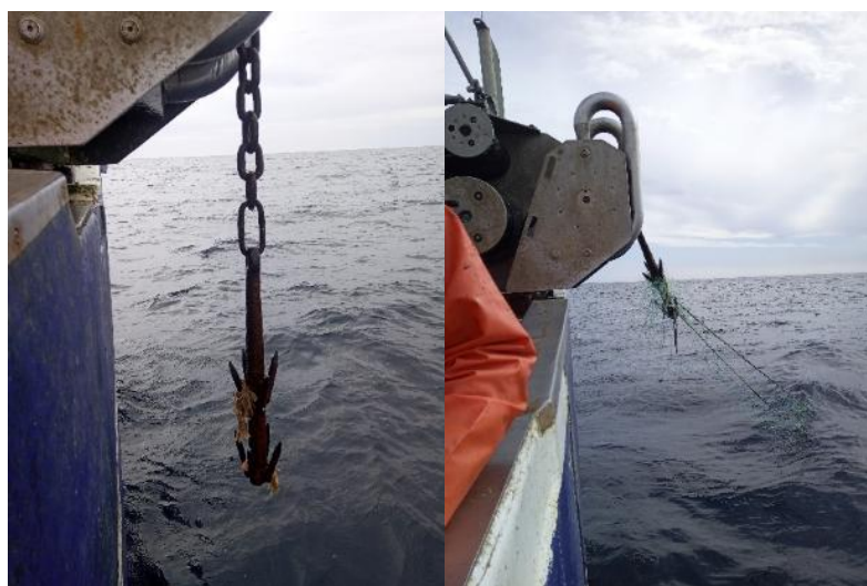
Figure 3-2-2 : Exemple de grappin utilisé pour récupérer un filet maillant (pêcherie ciblant des démersaux sur épave, Danemark)
