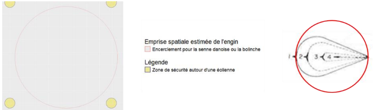
Figure 2-8 - Représentation en vue de dessus de l'empreinte spatiale de l'encerclement pour les sennes et bolinches. Adapté de [FAO, 1988]
