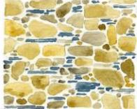
appareillage de moellons de granite et pierres de schiste, non assisés.
