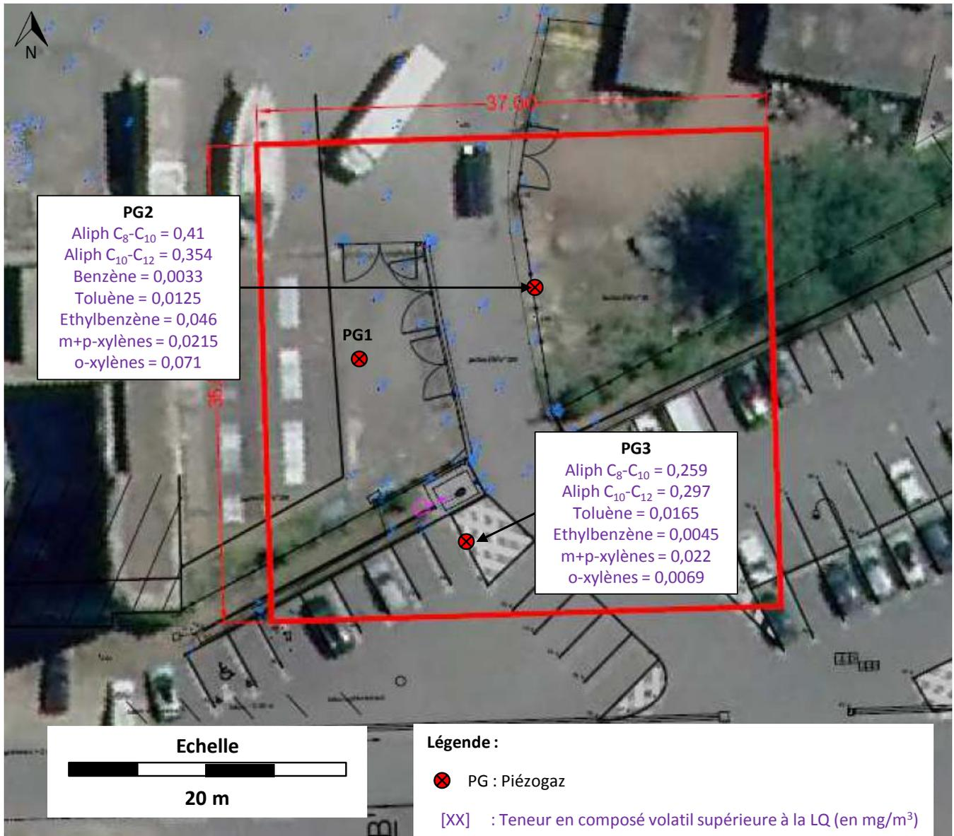
Figure 10 : Cartographie des composés détectés sur les gaz du sol
