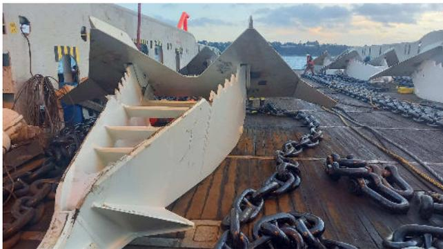
portuaires en état, le choix a donc été fait d'investir dans un **nouveau système de mouillage** en conservant un **type d'ancrage mobile** (ancres principale et secondaire de **9,75 tonnes** chacune).
