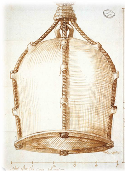
Dessin d'une cloche de plongée pour la récupération des objets du fond de la mer et la pêche de perles, conçue par José Bono Giuseppe 1583. © Espagne, AGI, MP-INGENIOS, 5.
